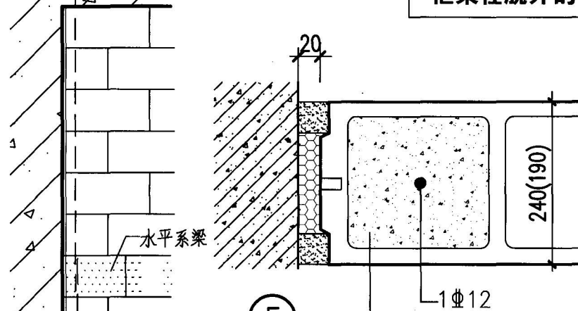
190、240厚砌块墙与 框架柱脱开的构造
